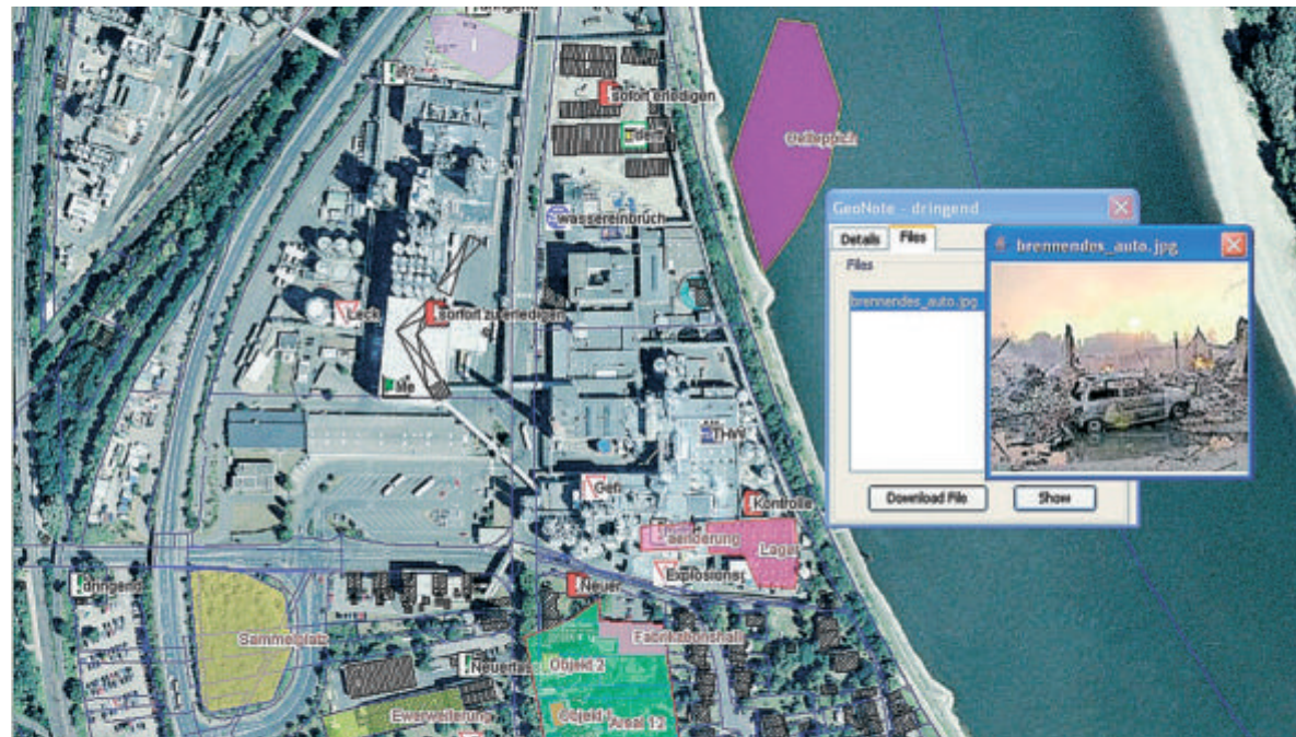
Elektronische Lagekarten führen die Informationen aus den unterschiedlichen Datenquellen zusammen und ermöglichen damit schnellere und bessere Reaktionen im Krisenfall. Foto: iSpace
