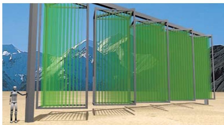
Die Idee senkrecht stehender Foto-Bio-Reaktoren zur Züchtung von Mikroalgen war 2008 einen „Genius“-Preis wert. Grafik: Ecoduna
