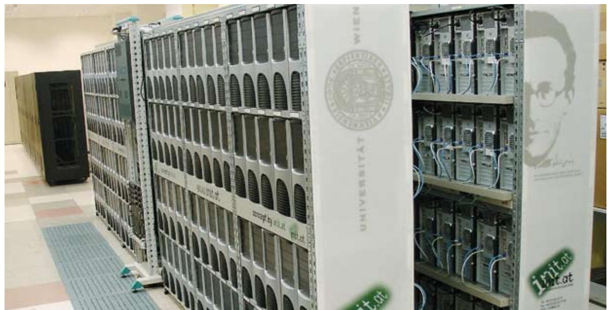
„Schrödinger III“ ist der derzeit schnellste Supercomputer in Österreich. 240 Rechner erreichen nicht weniger als 1,14 Billionen Rechenoperationen pro Sekunde. Foto: init.at
