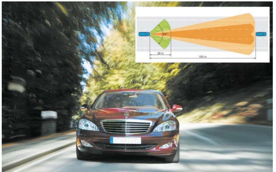
Die Mercedes-Ingenieure planen die Vernetzung mit dem radar-basierten Bremsassistenten BAS Plus (Grafik), der die Distanz zu vorausfahrenden Autos mittels zweier Radarsysteme erfasst: Bis zu einer Entfernung von 150 Metern wird das Umfeld mit einem Radar überwacht. Foto: DaimlerChrysler
