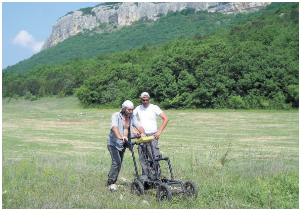
Die Experten von „Archeo Prospections“ bei der Arbeit mit dem Georadarmessgerät auf der Krim. Mit diesem Instrument lassen sich Mauern und Steinstrukturen gut lokalisieren. Foto: ZAMG Geophysik
